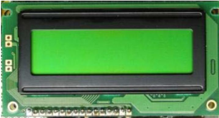
**Bild 18: Installiertes Dotmatrix Display (Beispielbild)**
