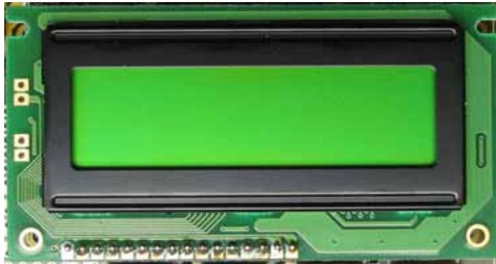
**Bild 4-12: Installiertes Dotmatrix Display**
