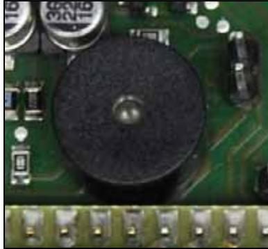
**Bild 4-15: Eingesetzter Lautsprecher**
